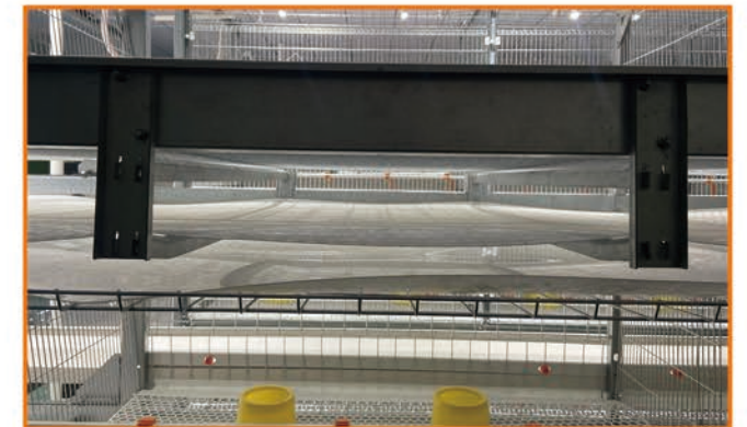
粪带两端有出风口，保持鸡粪干燥，并且冲粪时方便冲洗
