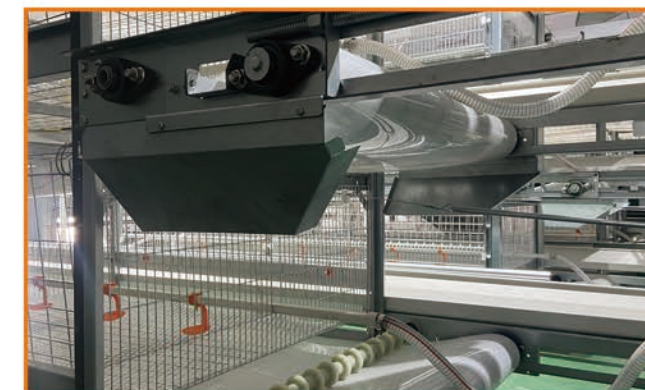
有“簸箕”防止鸡粪掉落地上，还有机尾轴内刮粪板
