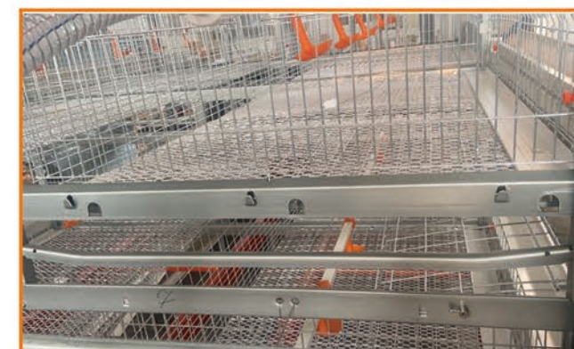
拖粪带处是弧形，底网有三根杆支撑
